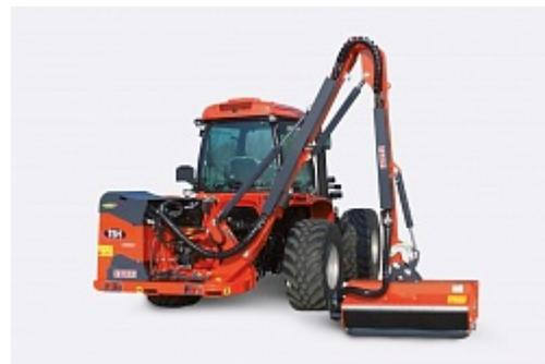
Надежность и долговечность данной косилки превосходит ожидания и пользуется большим спросом у дорожно-строительных и коммунально-уборочных организаций. На косилках серии TSH Energy установлена гидравлическая защита от столкновения с препятствиями.
