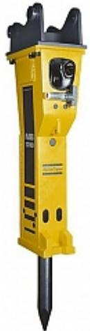
Гидромолоты MB среднего класса являются чрезвычайно эффективным оборудованием. Молоты приводятся в действие с помощью масла и газа, что уменьшает их зависимость от гидравлической системы. 70% энергии удара образуется газом в поршневой камере и только 30% – маслом гидравлической системы носителя. Поступающая энергия оптимизируется и усиливается с помощью внутреннего регулирующего клапана.
